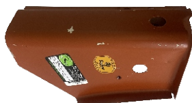
035/036-EX - PÉ DE COLUNA LATERAL CHAPA 0,90 PEÇA E 1,5 REFORÇO (EXPORTAÇÃO) VERMELHO E/D
